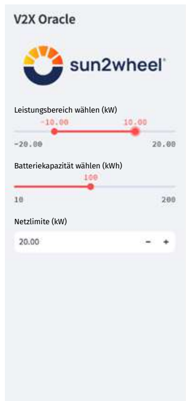
Abb. 1: Darstellung des Prototyps eines einfachen Online-Simulators. Der Kunde kann jederzeit einen minimalen Ladezustand vorgeben, innerhalb dessen die Optimierung den Ladefahrplan mit den höchsten Einsparungen oder Erträgen berechnet.
