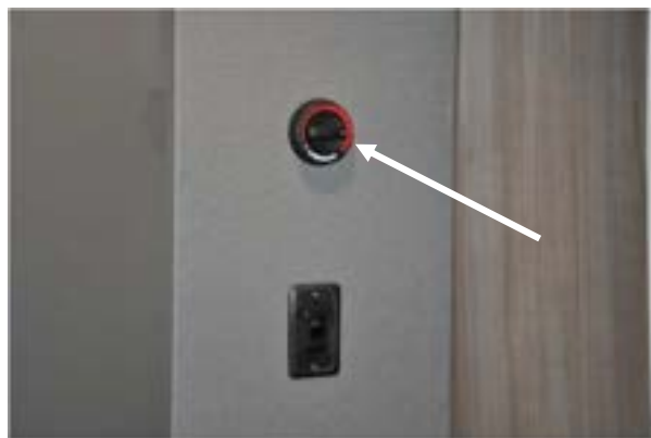
PHOTO E-63 Interrupteur du thermostat (situé au fond du véhicule, LX et LDX)
