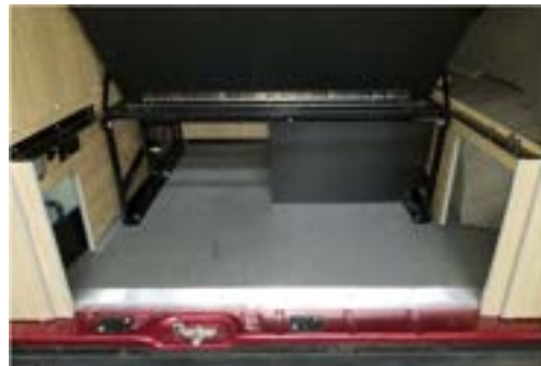
PHOTO E-35 Rangements sous la banquette-lit
