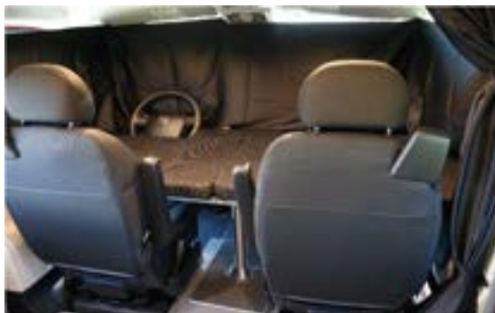
PHOTO E-52 Lit avant installé (avec rideaux)
