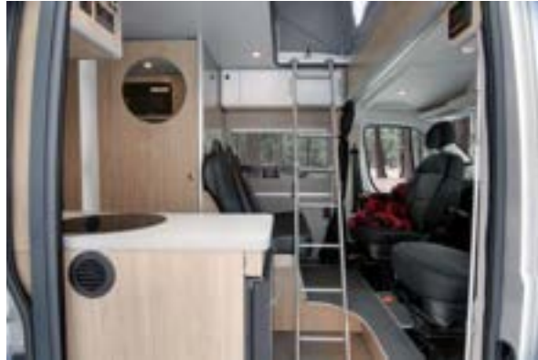
PHOTO E-72 Échelle pour monter sur le toit
