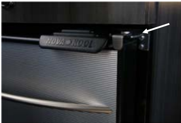
PHOTO E-11 Loquet de métal pour verrouiller la porte du réfrigérateur
