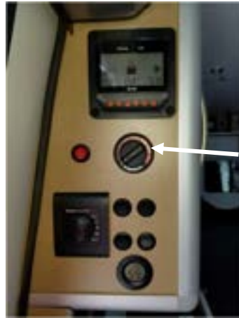
PHOTO E-64 Interrupteur du thermostat (XL Plus et XL FLEX Style Go Van)
