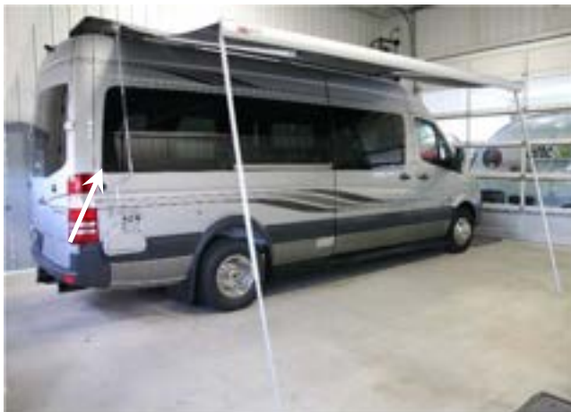
PHOTO F-14 Supports verticaux en angle
