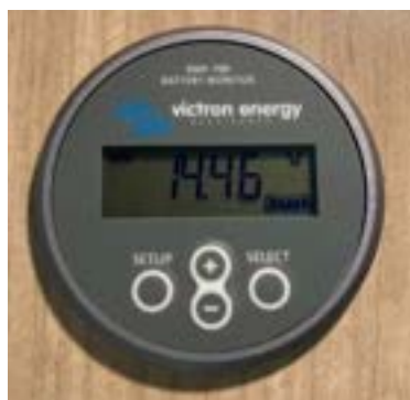
PHOTO C-5 Moniteur de batteries au lithium
