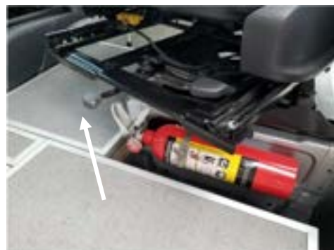
PHOTO E-59 Mécanisme pour faire pivoter le siège avant
