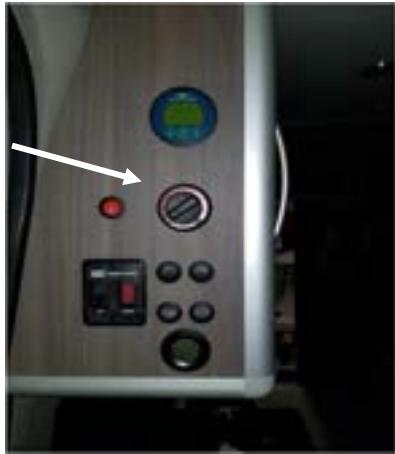
PHOTO E-64 Interrupteur du thermostat (XL Plus et XL FLEX)
