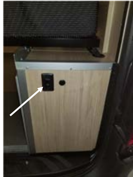
PHOTO E-38 Second interrupteur du lit ajustable situé à l'arrière du véhicule
