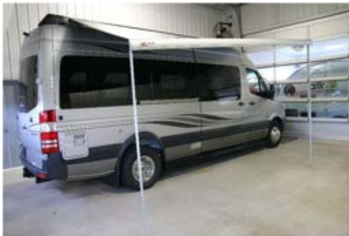
PHOTO F-19 Auvent incliné à l'arrière
