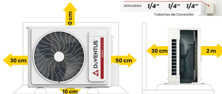
Medidas recomendadas para una buena dispersión del calor
