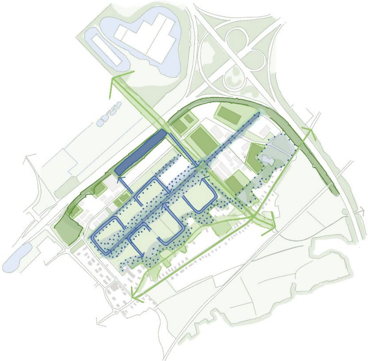
Figuur 32. Voorbeelduitwerking van robuust en klimaatadaptief Hattermerbroek: vasthouden, vertragen en bergen in de fluctuatiezone
