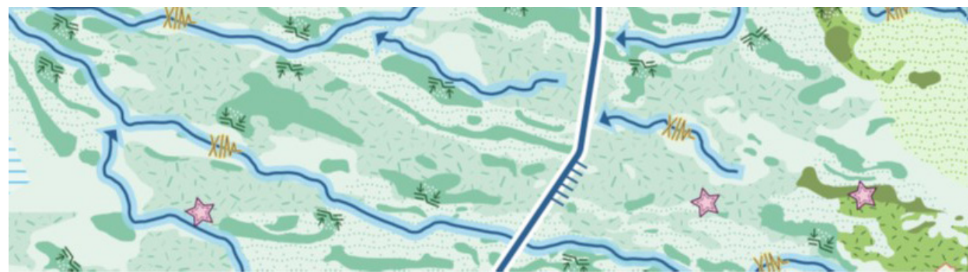
▲ Uitsnede van de sponskaart voor Sallandse Weteringen. Vertragen kan hier bijv. door de watergangen meer te laten meanderen, door groenblauwe dooradering van het landschap, door drainerende elementen te verwijderen en vergroten van areaal aan oppervlaktewater.
