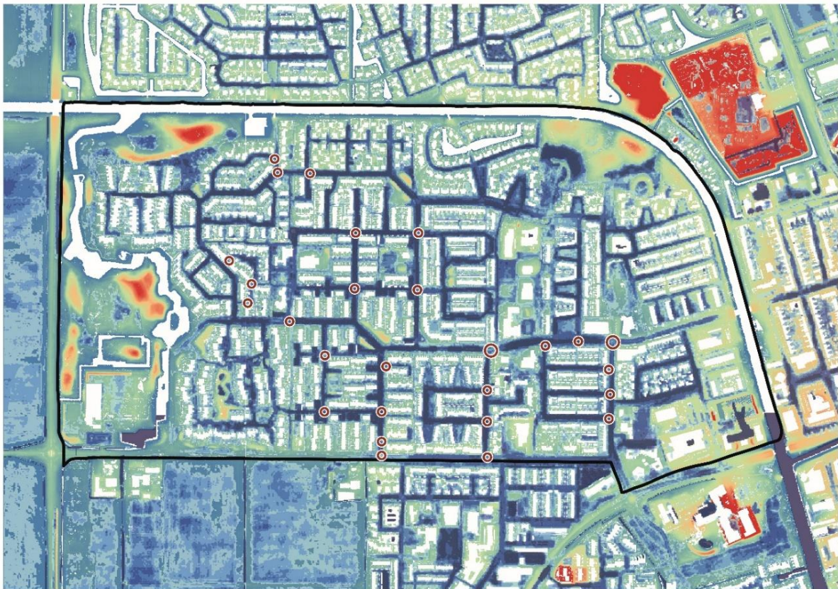
Figuur 40. Hoogteligging en een bui van 140mm/2uur. Water blijft in de straten staan door kleine diameter riool, hoge drempel van de overstort, slecht afstromen van water door onder andere drempels en slecht infiltreren door hoger gelegen groen.
