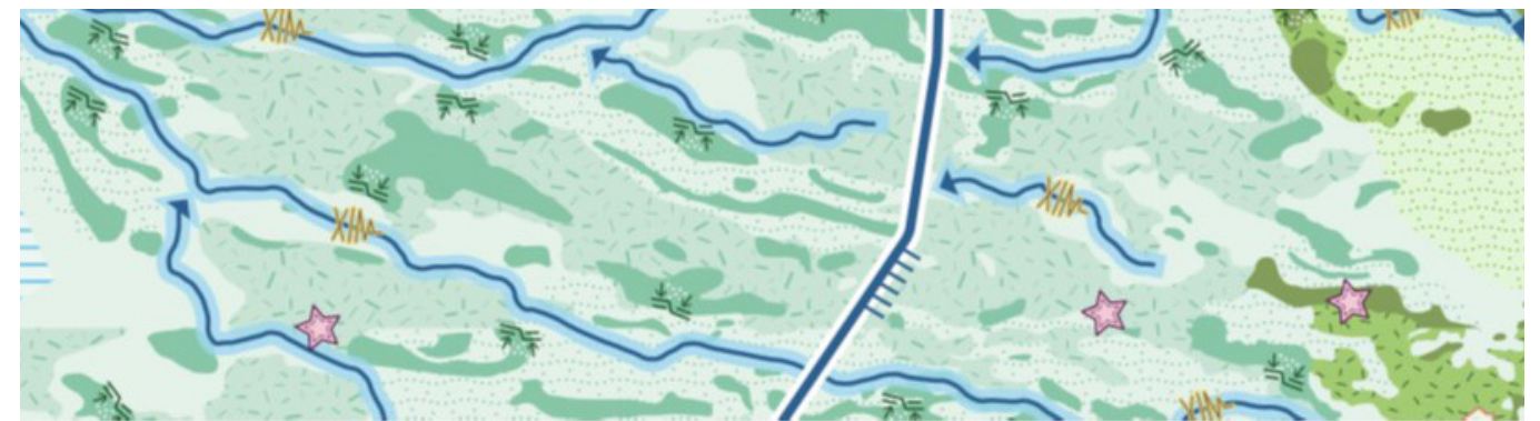
^ Uitsnede van de sponskaart voor Sallandse Weteringen. Vertragen kan hier bijv. door de watergangen meer te laten meanderen, door groenblauwe dooradering van het landschap, door drainerende elementen te verwijderen en vergroten van areaal aan oppervlaktewater.
