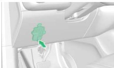
La caja de fusibles del panel de instrumentos se encuentra en el lado del conductor del panel de instrumentos. Retire la placa de la cubierta inferior izquierda del panel de instrumentos para comprobar y sustituir el fusible.
