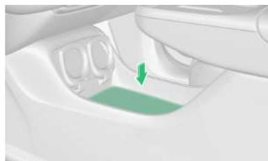
La caja de almacenamiento inferior delantera central está situada debajo del panel de instrumentos.
