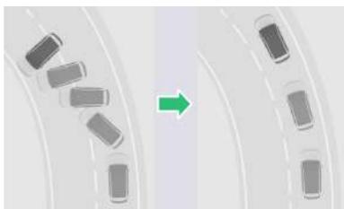
Si el vehículo tiende a sobrevirar (es decir, hacer derrape en cola), el sistema aplica principalmente el frenado en la rueda delantera del lado exterior de la curva.
