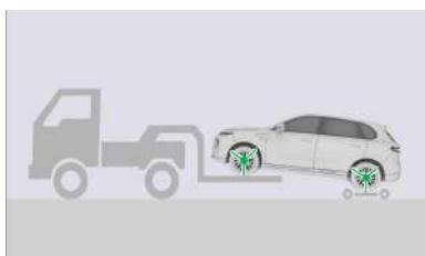
Si se utiliza un remolque elevador de ruedas para remolcar un vehículo desde la parte delantera del vehículo, debe
