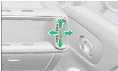
Gire la palanca de ventilación hacia la izquierda o hacia la derecha para ajustar la dirección del flujo de aire de ventilación.
