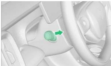
Gire la palanca de control de las luces hacia el volante para encender las luces de largo alcance. Después de que suelte la palanca, ésta volverá automáticamente a su posición original y la luz de largo alcance se apagará. Puede avisar a los demás usuarios de la carretera de su intención de adelantar haciendo flasheo de las luces de largo alcance.
