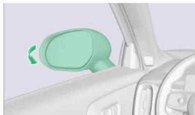
Empuje el espejo retrovisor exterior hacia la parte trasera del vehículo para plegarlo.
