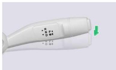
Con la función de control de centrado en el carril (LCC) disponible, el conductor activa la función de control de centrado en el carril (LCC) pulsando la palanca de cambios de columna hacia abajo dos veces consecutivas. Cuando la función está activada, se enciende el indicador correspondiente en el cuadro de instrumentos.
