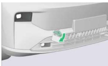
3. Atornille el gancho de remolque en el orificio de montaje del gancho de remolque en el sentido de las agujas del reloj y apriételo.\*
