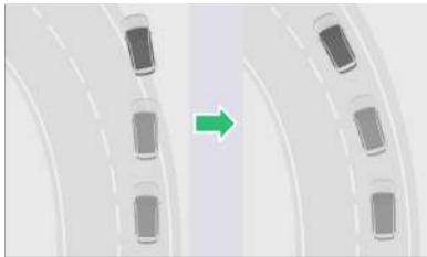
Si el vehículo tiende a subvirar (es decir, el radio de giro es demasiado grande), el sistema aplica principalmente el frenado en la rueda trasera interior de la curva.
