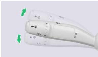
Después de encender el vehículo, gire la palanca de control de luces hacia abajo para encender la luz indicadora de dirección izquierda; gire la palanca de control de luces hacia arriba para encender la luz indicadora de dirección derecha.
