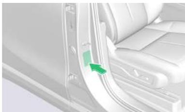
La placa del vehículo está situada en el lado derecho del vehículo, en el panel exterior del pilar B. La placa del vehículo está etiquetada con la marca, el número de identificación del vehículo (VIN), los parámetros de masa del vehículo y otra información.
