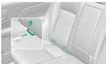
2. Coloque el asiento infantil en el asiento trasero, busque el punto de fijación inferior e introduzca la ranura de la guía de montaje inferior del asiento infantil en el punto de fijación inferior en el hueco del cojín del asiento hasta que se oiga un sonido de enganche.
