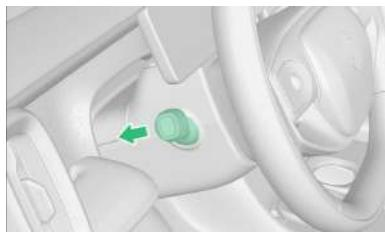
Con las luces de cruce en encendidas, presione la palanca de control de las luces alejándola del volante, tal como indica la flecha, para encender las luces de largo alcance. Al mismo tiempo, se iluminará el indicador luminoso de las luces de largo alcance en el cuadro de instrumentos.
