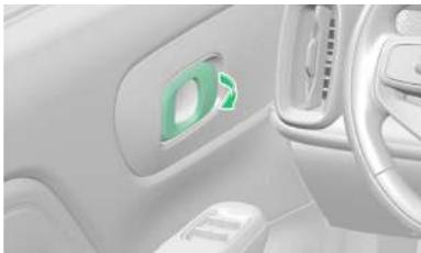
Cuando el vehículo esté bloqueado, tire hacia arriba del tirador interior de apertura de puerta para desbloquear la puerta lateral correspondiente. Tire otra vez del tirador interior de apertura de puerta arriba para abrir la puerta.
