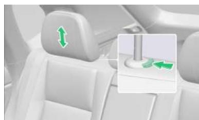
Subir: Tire del reposacabezas hacia arriba hasta la posición adecuada y ajuste la altura del reposacabezas hacia arriba.
