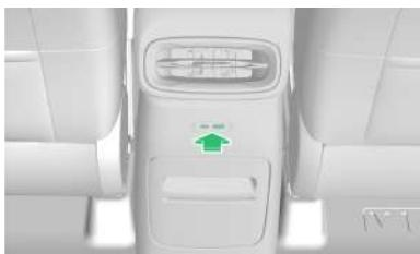
El asiento trasero está equipado con 1 puerto tipo A (que admite 12 W) y 1 puerto tipo C (que admite 15 W) para cargar.
