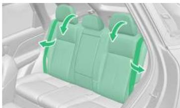
2. Tire de la correa del cinturón de seguridad en ambos lados del asiento trasero hacia la puerta, tire del respaldo del asiento trasero hacia adelante, suelte la correa del cinturón de seguridad y abata el respaldo del asiento trasero.
