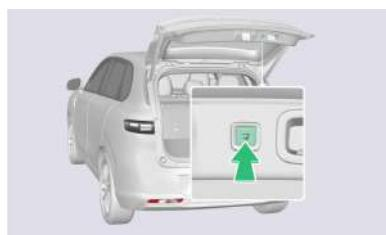
Cuando el vehículo está en estado parado, si se abre el portón trasero eléctrico, pulse el interruptor interior del portón trasero y éste se cerrará automáticamente.
