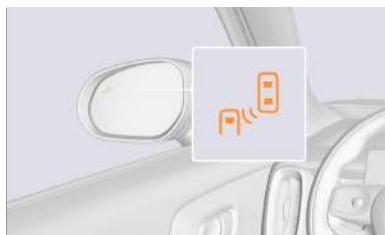
Cuando el vehículo está estacionado, el sistema detecta que otro vehículo ha entrado en el rango de detección de ángulo muerto. Si el conductor tiene intención de abrir la puerta en ese momento, el sistema se lo recordará encendiendo o parpadeando el indicador de detección de ángulo muerto en el espejo retrovisor.
