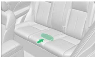
La caja de fusibles trasera está situada debajo del cojín del asiento trasero. Retire el cojín del asiento trasero para comprobar y sustituir el fusible.
