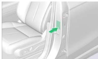
La señal de presión de neumáticos está situada en el panel exterior del pilar B izquierdo.
