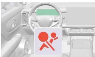
Al encender el vehículo, se ilumina el testigo indicador de mal funcionamiento (MIL) del airbag en el cuadro de instrumentos y se apaga cuando el sistema completa su comprobación automática. Si se produce alguna de las siguientes situaciones, indica un fallo del sistema:
