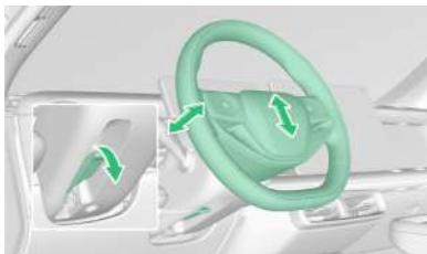
Antes de conducir el vehículo, ajuste la posición del volante según sus necesidades.
