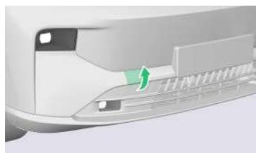
2. Abra la placa de la cubierta del gancho de remolque haciendo palanca en la dirección indicada en la placa de la cubierta del gancho de remolque situada en la parte inferior derecha del frontal del vehículo.
