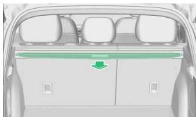
Los protectores de carga pueden utilizarse para cubrir el equipaje para mayor privacidad y protección contra la luz solar directa. Para utilizarla, sujeté la manilla situada en el extremo trasero de la protección de carga para extraer la cortinilla y cuelgue los postes limitadores de ambos extremos de la cortinilla en las ranuras deslizantes de los paneles embellecedores interiores correspondientes.
