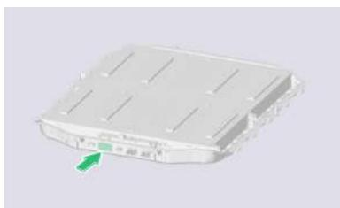
La placa de características de la batería de potencia se encuentra en el exterior del paquete de baterías.
