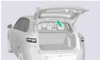
La etiqueta con el modelo y el número del motor de propulsión se encuentra en el panel interior de la puerta levadiza.
