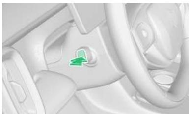
Mantenga pulsado el botón de encendido del lavado. El limpiador frontal rociará líquido de lavado, seguido de tres ciclos de limpieza a baja velocidad del limpiaparabrisas. Transcurridos unos segundos, el limpiaparabrisas realizará un único barrido adicional antes de cesar su funcionamiento.
