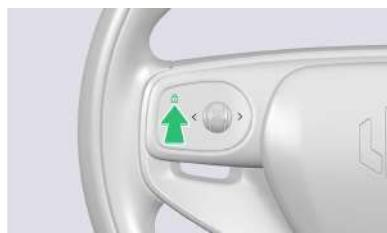
Cuando todas las puertas estén cerradas, pulse el botón de desbloqueo/bloqueo de todo el vehículo situado en el volante para desbloquear/bloquear todas las puertas.
