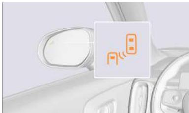
Cuando el vehículo esté dando marcha atrás y el sistema detecte vehículos que se aproximan por ambos lados en la parte trasera, el sistema alertará al conductor iluminando o parpadeando el indicador de detección de ángulo muerto en el espejo retrovisor.
