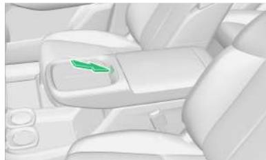
Pulse el botón de desbloqueo de la tapa de la caja de almacenamiento para abrir la caja de almacenamiento del reposabrazos central.
