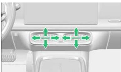
Mueva la palanca de ventilación hacia arriba y hacia abajo para ajustar la dirección del flujo de aire de ventilación.
