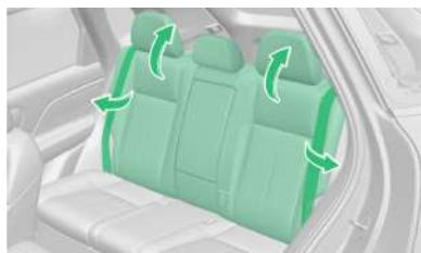
1. Tire de la correa del cinturón de seguridad en ambos lados del asiento trasero hacia la puerta, levante el respaldo del asiento trasero y empújelo hacia atrás hasta la posición de bloqueo. Cuando oiga un «clic» y el indicador rojo de la hebilla de desbloqueo quede completamente oculto, el respaldo estará totalmente bloqueado.
