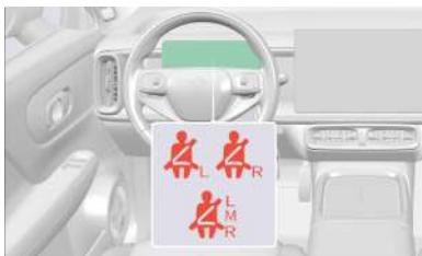
Cuando el vehículo está en movimiento, si el conductor o el ocupante no llevan abrochado el cinturón de seguridad, se encenderá la luz indicadora correspondiente del cinturón de seguridad en el cuadro de instrumentos e irá acompañada de un tono de aviso, hasta que se abroche el cinturón de seguridad; a continuación, la luz indicadora se apagará y el tono de aviso cesará.
