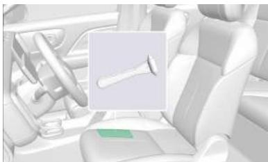
Se coloca un martillo de emergencia para coches debajo del asiento del conductor. Cuando se encuentre en una emergencia (y no pueda subir o bajar la ventanilla del coche), utilice un martillo de emergencia para coches para romper la ventanilla y escapar.
