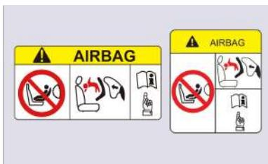
Una etiqueta de advertencia de airbag en la visera del lado del pasajero delantero recuerda al pasajero delantero de los peligros de la expansión del airbag, y el sistema de retención infantil orientado hacia atrás no debe utilizarse en asientos protegidos por airbags frontales (en estado activado). Asegúrese de leer y seguir las instrucciones en la etiqueta.
