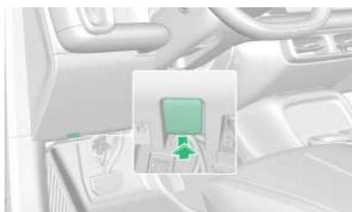
1. Tire dos veces seguidas de la manilla de desbloqueo del capó, situada en la esquina inferior izquierda del panel de instrumentos, y el capó se
