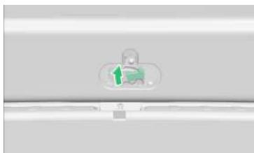
3. Gire el interruptor de bloqueo de emergencia del portón trasero en el sentido de las agujas del reloj para desbloquear el portón trasero, y empuje el portón hacia fuera.
