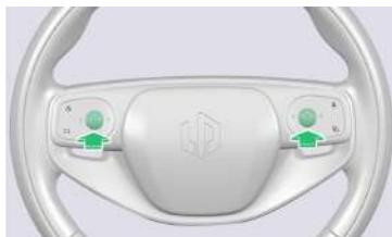
2. Desplace la rueda izquierda/derecha del volante hacia arriba y hacia abajo para ajustar el ángulo de los retrovisores exteriores izquierdo/derecho hacia arriba y hacia abajo. Gire la rueda izquierda/derecha situada en el lado izquierdo/derecho del volante para ajustar el ángulo del espejo retrovisor exterior izquierdo/derecho.
