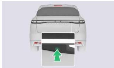
Cuando el vehículo está desbloqueado y en estado parado, si el portón trasero está cerrado, pulse el interruptor exterior del portón y el portón trasero se abrirá automáticamente a la altura establecida.
