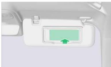
Los espejos de cortesía están situados en los parasoles principal y del pasajero delantero; después de abrir el parasol hacia abajo, levante la placa de la cubierta del espejo de cortesía hacia arriba.
