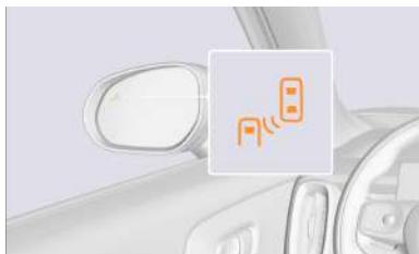
Cuando el vehículo avanza a una velocidad no inferior a 10 km/h (6 millas/h), el sistema avisa al conductor encendiendo o haciendo flasheo el indicador de detección de ángulo muerto en el espejo retrovisor cuando detecta que otro vehículo ha entrado dentro del ángulo muerto, evitando incidentes durante la conducción.
