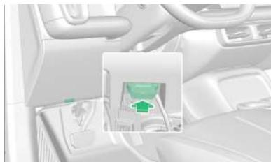
La interfaz OBD se encuentra en la parte inferior izquierda del panel de instrumentos y permite leer datos como el número de identificación del vehículo (VIN) y la información del estado del vehículo mediante una herramienta de diagnóstico específica.
