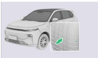
Los neumáticos están equipados con marcas de desgaste. El dibujo triangular en el hombro del neumático se utiliza para indicar la posición de la
