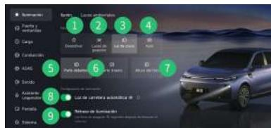
Los interruptores de las luces exteriores están integrados principalmente en la pantalla de infoentretenimiento. Las luces del vehículo pueden controlarse en la interfaz «Ajustes - Luces» de la pantalla de infoentretenimiento:
