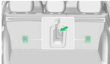
3. Presione y mantenga presionado el muelle, luego pase la correa superior a través del anclaje de la correa superior en la parte posterior del respaldo. Tenga cuidado de no retorcer la cinta de anclaje superior. Al asegurar, asegúrese de pasar la correa de anclaje superior por debajo del reposacabezas. Si el reposacabezas interfiere con la instalación del asiento infantil, retírelo o levántelo a la posición más alta.
