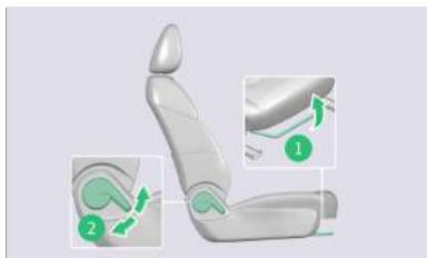
Tire de la palanca de desbloqueo hacia arriba en la dirección indicada por la flecha ①, luego apoye ligeramente su cuerpo contra el asiento y deslice el asiento hacia adelante o hacia atrás. Suelte la palanca de desbloqueo y el asiento dejará de deslizarse, aplique una ligera fuerza hacia adelante o hacia atrás con la carrocería, escuchará un sonido de "clic" y el asiento quedará bloqueado.
