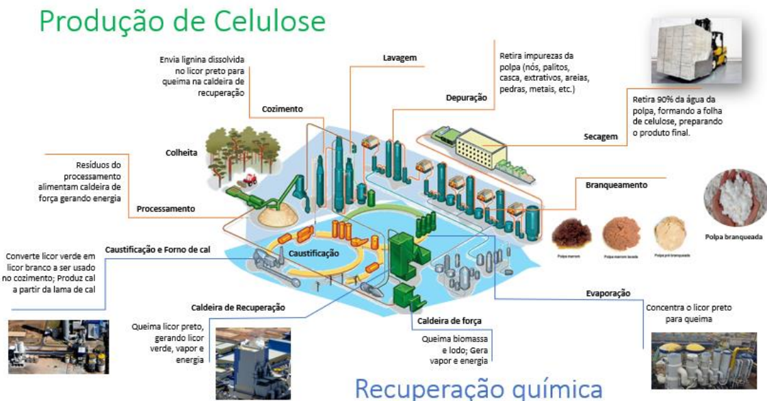
Figura 3. Processo de produção de Celulose nas Fábricas 1 e 2 na Suzano, unidade de Três Lagoas (MS).
