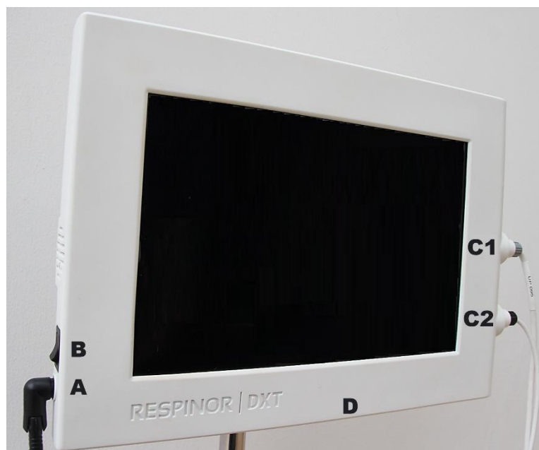
Figura 3. DXT Control Unit. A: Interruptor de encendido, B: Conector de alimentación, C1: Conector del DXT Anterior Sensor, C2: DXT Posterior Sensor connector, D: Puerto de servicio.
