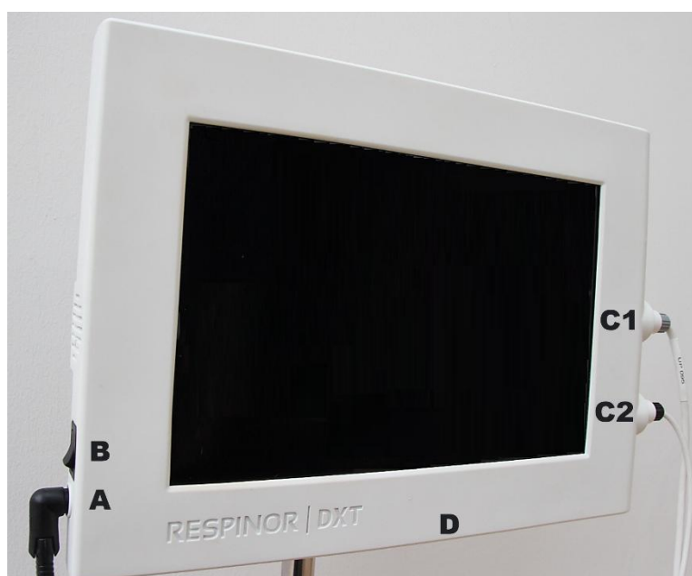
Figure 3. DXT Control Unit. A : Interrupteur d'alimentation, B : Connecteur d'alimentation électrique, C1 : Connecteur du DXT Anterior Sensor, C2 : Connecteur du DXT Posterior Sensor, D : Port de service.
