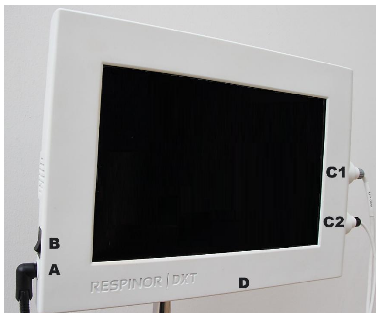
Afbeelding 3. DXT Control Unit. A: Stroomschakelaar, B: Connector voedingseenheid, C1: Connector voor DXT voorste sensor, C2: Connector DXT achterste sensor, D Servicepoort.
