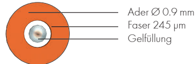
CW-Ader (Kompaktader) gelgefüllt 0.9 mm Standardader für Simplex-, Duplex- und Breakout-Kabel
