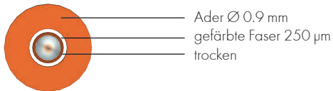
CH-Ader (Kompaktader) ohne Gel 0.9 mm Standardader für Pigtails
