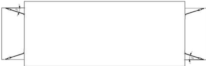
Figuur 3: Boven aanzicht (longitudinale sjorhoeken: \beta_x \leq 40^\circ ) - niet kruiselingse variant
