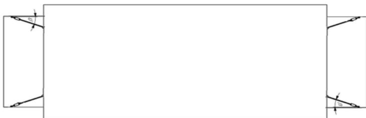
Figure 3 : Vue en plan (angles d'arrimage longitudinaux :  $\beta_x \leq 40^\circ$ ) – variante non croisée
