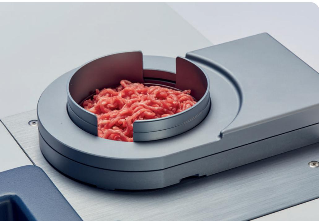
Исследование фарша в чашке Петри из полистирола на интегрирующей сфере спектрометра MPA II
