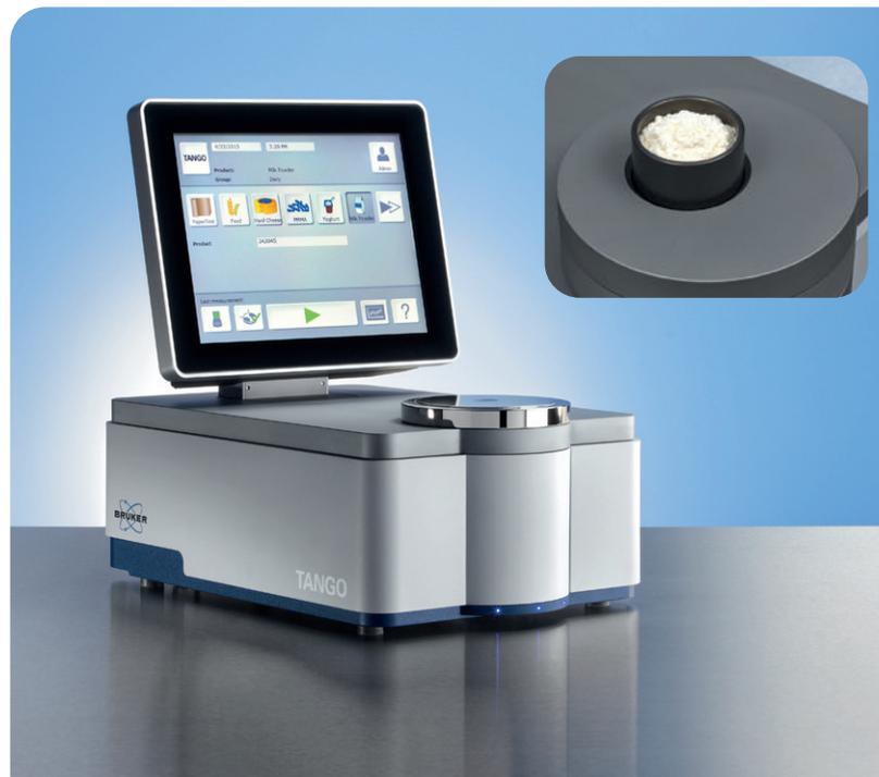
Исследование муки, насыпанной в стакан из кварцевого стекла, на интегрирующей сфере FT-NIR спектрометра TANGO-R
