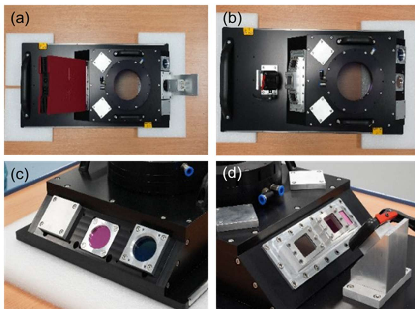
Abbildung 6: Umsetzung des neuen Anlagendeckels (a) mit montierten Messgeräten, (b) ohne montierte Messgeräte, (c) eingebautes Germaniumfenster, (d) eingebauter Halter mit Infrarot-Spiegeln
