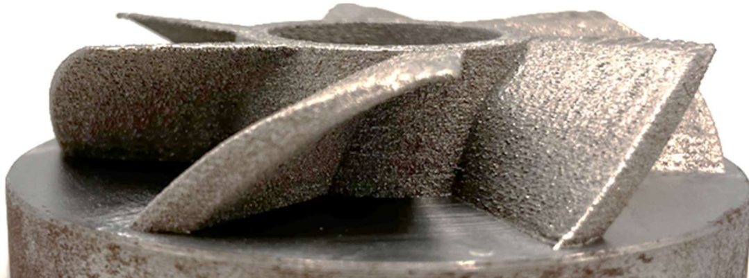
Abbildung 31: „Fotografie des Propellers mit aufgedickten Flügeln und Überhangswinkeln zwischen 10^\circ und 40^\circ , gefertigt aus Alloy 718. Die Bauteile wurden ohne Konturbelichtung hergestellt.“
