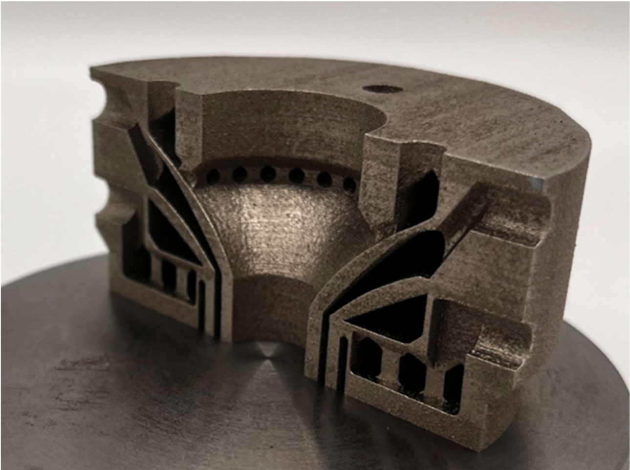
Abbildung 35: Brennerbauteil aus Alloy 718, vorbereitet mit der kommerziellen Pre-Processing-Software Genesis (Amsis GmbH, Deutschland). Das angewendete Hatching entspricht bestmöglichst den im Projekt entwickelten, optimierten Belichtungsstrategien.
