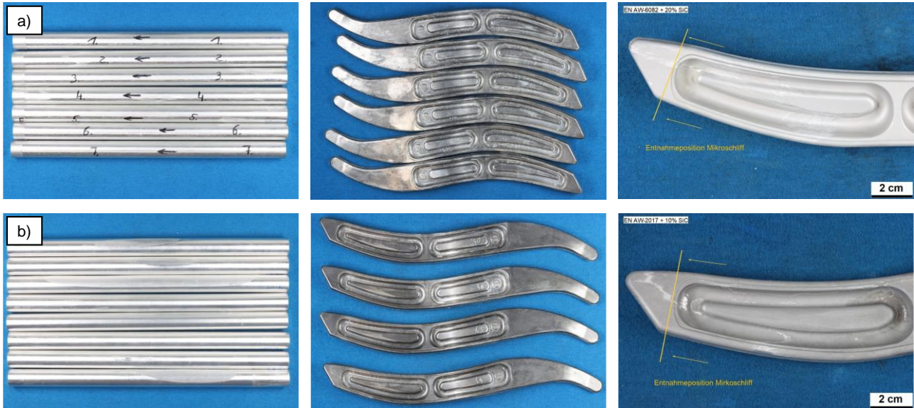
Abbildung 57: Schmiedebolzen und Schmiedebauteil: a) EN AW-6082 + 20 Vol.-% SiC p , b) EN AW-2017 + 10 Vol.-% SiC p .
