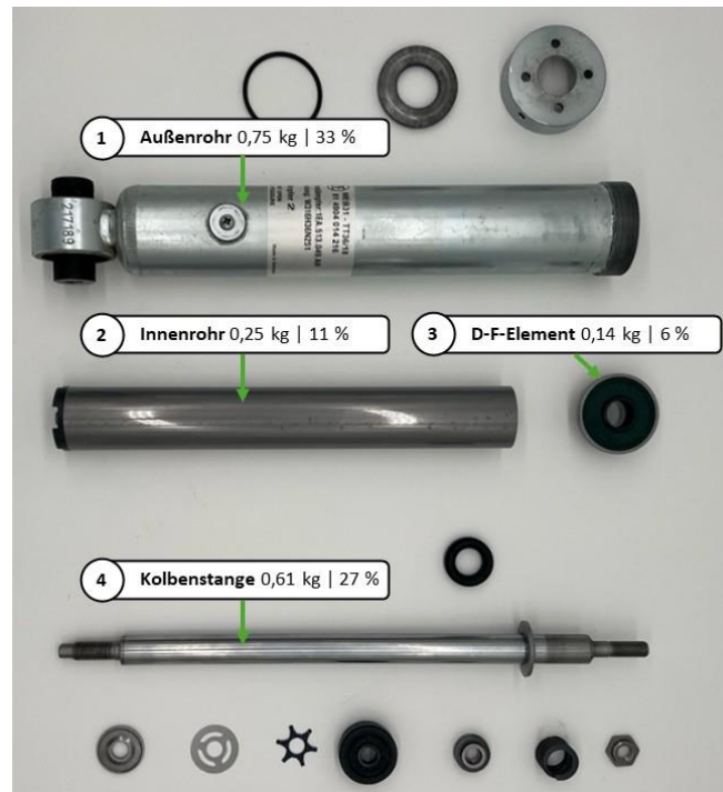
Abbildung 4: Demontierter Abstimmtdämpfer vom Typ 1EA.513.049.AH der VW AG; Beschriftete Bauteile mit hohem Substitutionspotenzial, Masse des Bauteils in kg | Prozentualer Anteil an der Gesamtmasse des Dämpfers.
