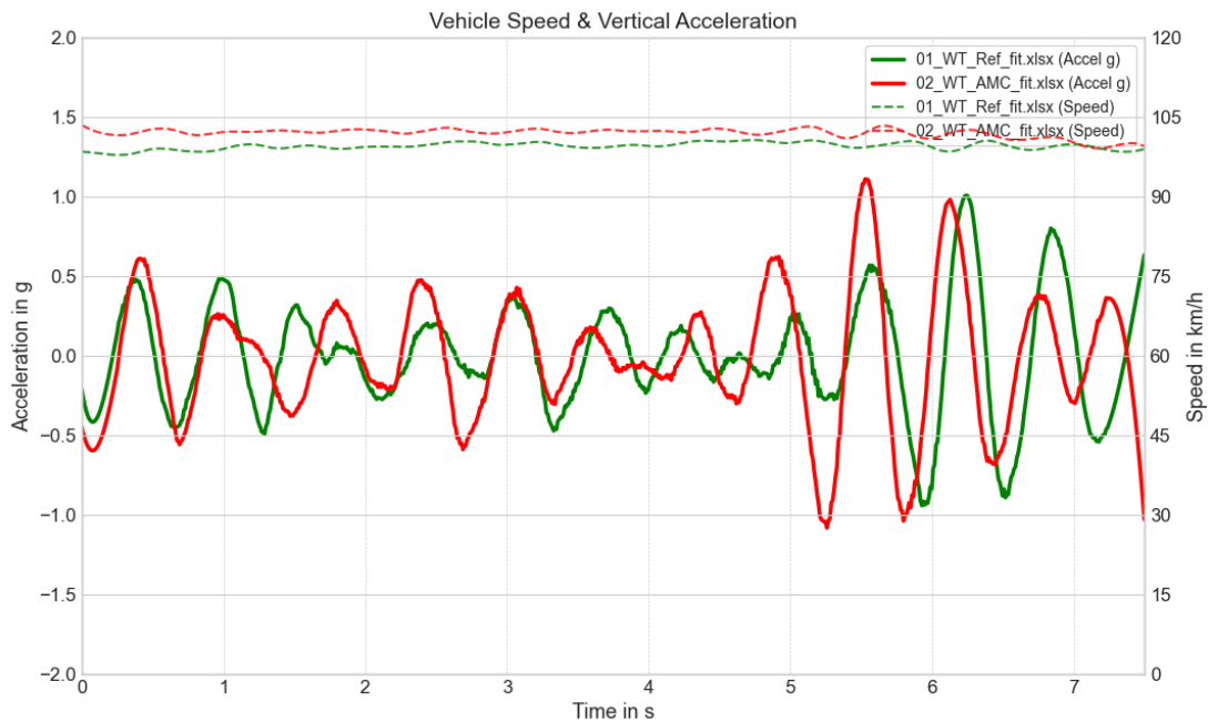
Abbildung 52: Vergleich der Aufbaubeschleunigung und Fahrgeschwindigkeit auf welliger Teerstraße bei 100 km/h für Referenz- und AMC-Setup.
