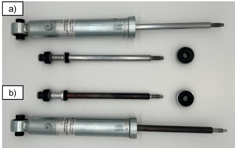
Abbildung 49: Abstimm dampfer von ZF a) Referenzkomponenten b) AMC-Kolbenstange mit DLC-Beschichtung und Dichtungs-Führungs-Element aus Aluminium.
