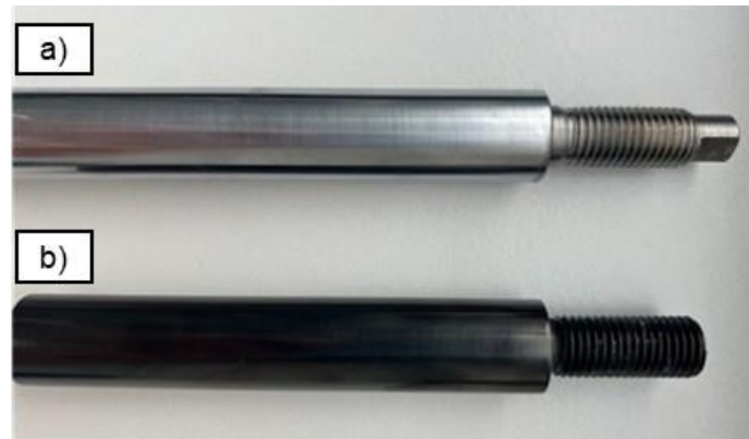
Abbildung 34: Kolbenstangenabschnitte aus a) Stahl hartverchromt b) AMC mit DLC beschichtet.
