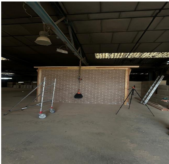
Montage avant lancement du sac
