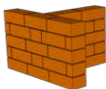
Principe d'appareillage des angles en T avec protection de l'about via une plinthe
