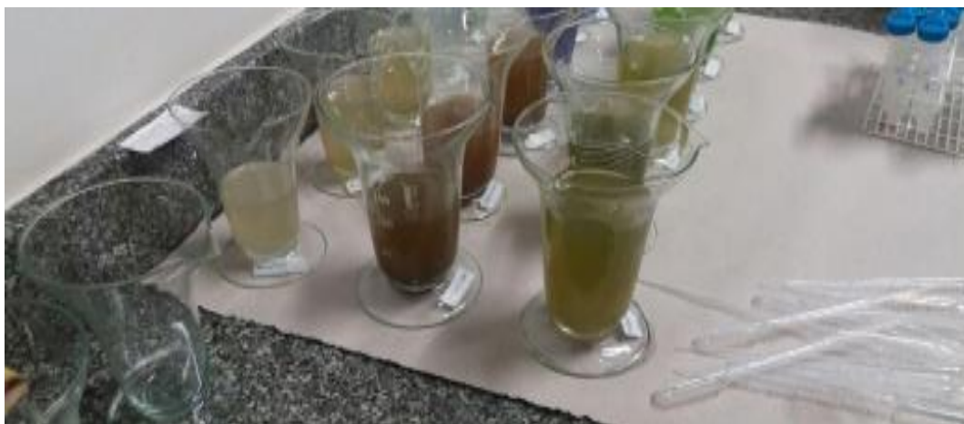
Figura 2 – Sedimentação espontânea em cálice graduado de vidro.
