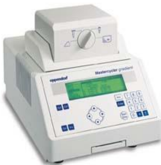
Figura 16: Esse processo é realizado no aparelho denominado termociclador, que executa alteração de temperatura. Fonte: sbq.com.br
