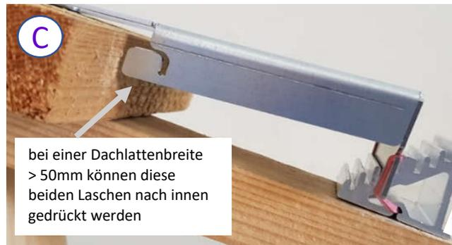
Die Universalklammer auf die Dachlatte aufsetzen und das Alu-Auflager mit einer Holzschraube Drm.=5mm (oder größer) fixieren.
