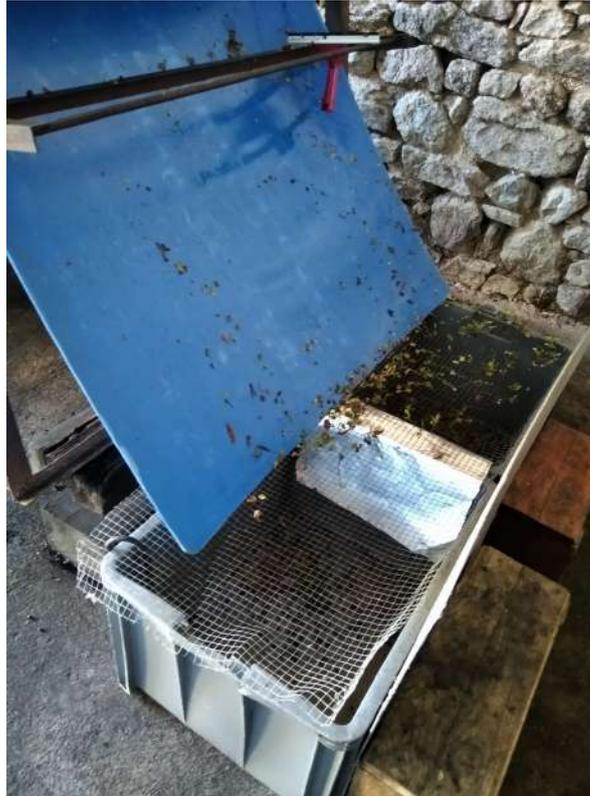
*Figure 31 - Crible servant à réceptionner les « déchets » à l'arrière de la trieuse*
