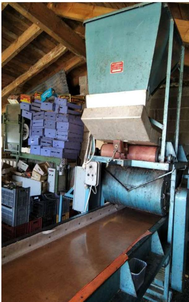
*Figure 28 - Ventileuse électrique avec tapis roulant (Ardèche).*
