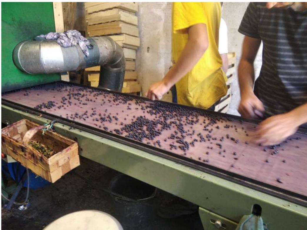
*Figure 29 - Un second tri à la main sur tapis roulant*
