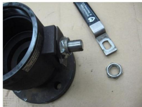
Imagen 6 – Extracción de la tuerca del vástago y la manija
