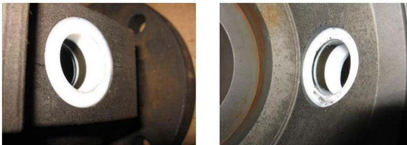
Imagen 9 – Extracción de la empaquetadura y la arandela de empuje
