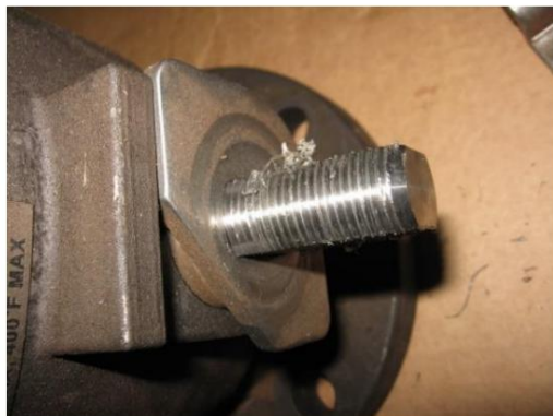
Imagen 7 – Extracción del tope de leva y del prensaestopas
