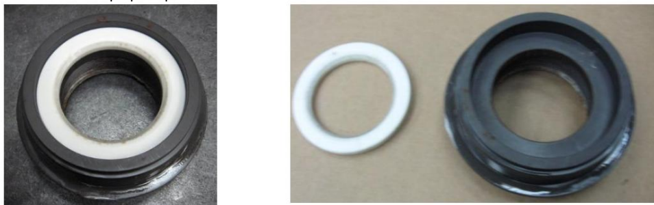
Imagen 3 – Extracción y desmontaje del retenedor
