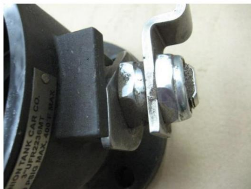
Imagen 6 – Extracción de la tuerca del vástago y la manija
