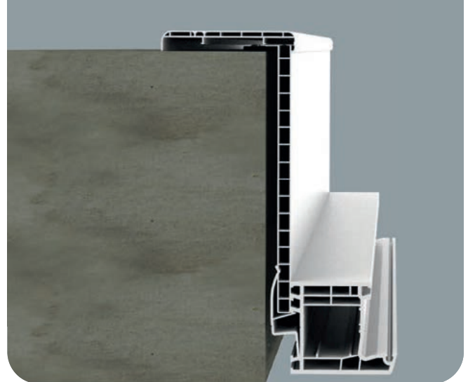
Laschensystem mit Kammerprofil an einer Fensterinnenlaibung
