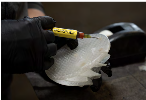
El equipo de la UNI tapa los orificios con cera (izquierda) y une el patrón al árbol (derecha) para realizar una fundición a la cera perdida automatizada usando un robot pick-and-place.
