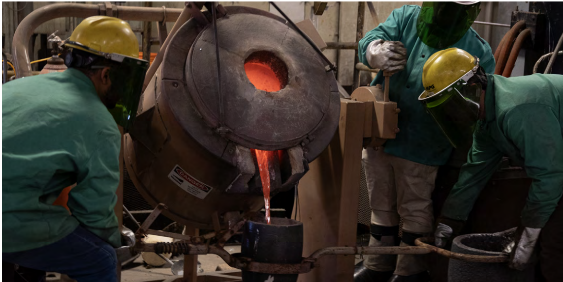
El equipo de la Universidad del Norte de Iowa (UNI) vierte metal de un horno en un crisol.
