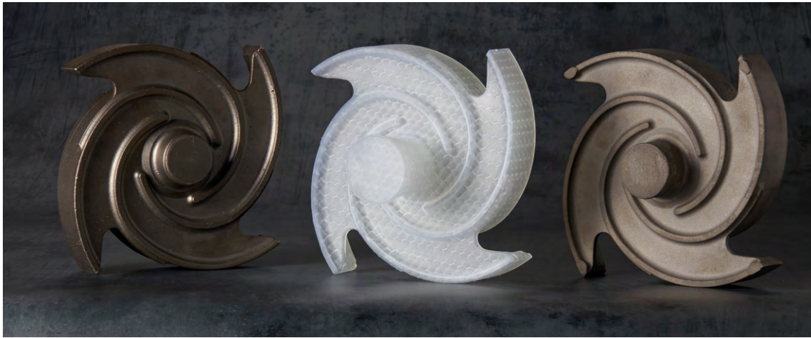
Rotor de titanio junto a su patrón de Clear Cast Resin.
