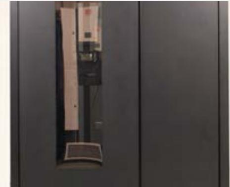
Diesem IBM Backup-Roboter entgeht nichts! Alle relevanten Daten werden zur Sicherheit hier zusätzlich zu einer bereits erfolgten Sicherung im Abrechnungszentrum noch einmal gesichert. Der Raum, in dem diese Sicherung erfolgt, widersteht einem Feuer mit 1.000 °C bis zu 200 Minuten, so dass die Daten selbst einen Supergau überstehen würden.
