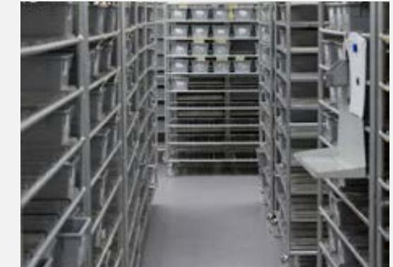
Im Haus werden Ihre Rezepte in von uns konzipierten und patentierten Rezeptwagen sicher transportiert. Die ergonomisch optimierte Eigenentwicklung bietet im Falle eines Feuers den perfekten Schutz. Die Abstände der Behälter im Rezeptwagen sind so berechnet, dass sie den mikrofeinen Löschnebel optimal seine Arbeit verrichten lassen.
