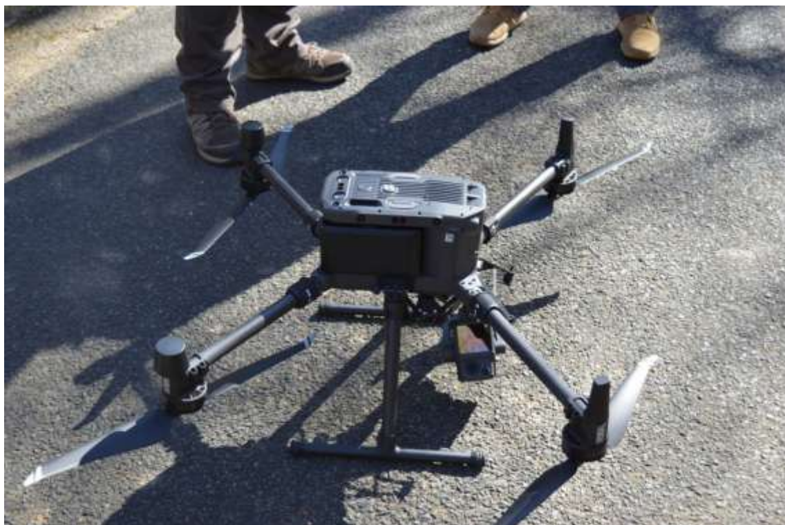
Le drone et sa caméra laser processionnelle. Définition : 1 cm (effectue un nuage de 3900 points au M 2 )
