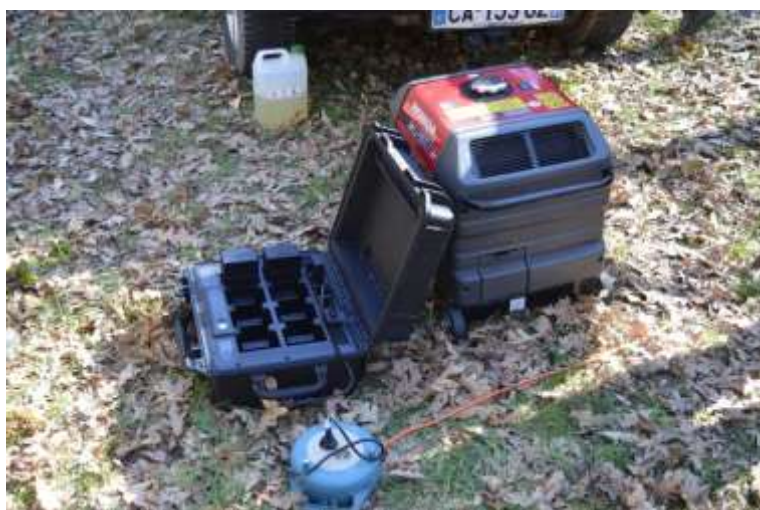
Groupe électrogène et chargeur de batteries.
