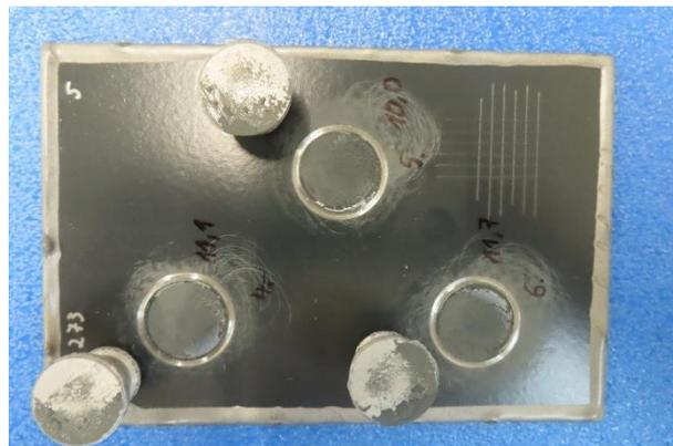
Bild 3: P1.5 – Gitterschnitt + Stempelabrisse
