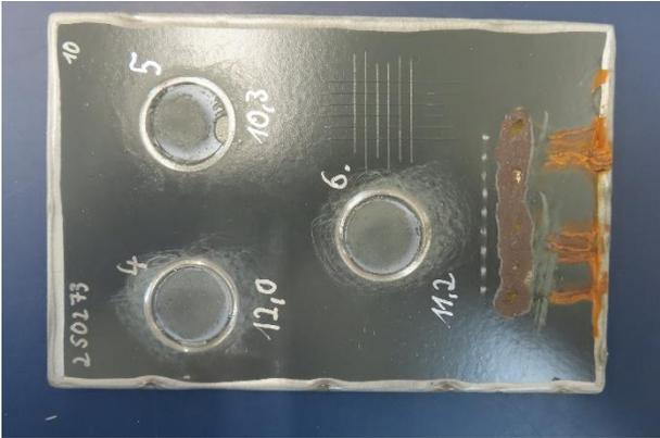
Bild 8: P1.10 – Gitterschnitt + Stempelabrisse
