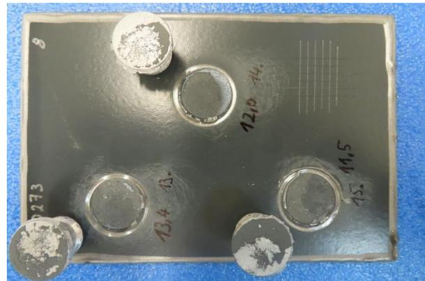
Bild 6: P1.8 – Gitterschnitt + Stempelabrisse
