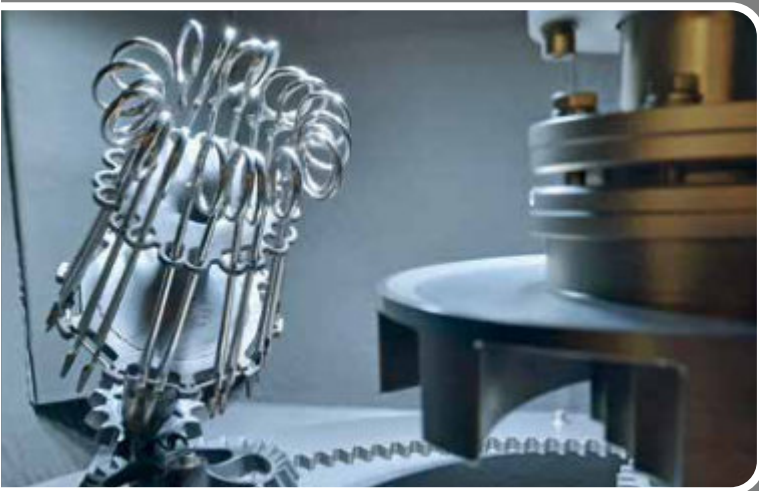
Werkstücke in einer Strahlanlage BMF TWISTER auf einem 3D-gedruckten Werkstückträger
