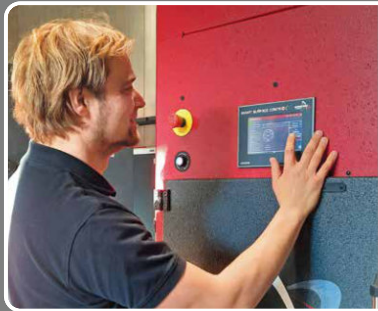
Die gewünschten Strahlparameter werden schnell und einfach an einem Touch Panel eingegeben
