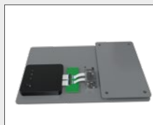
1. Connessione della FTF al tester tramite connettore ZIF.
