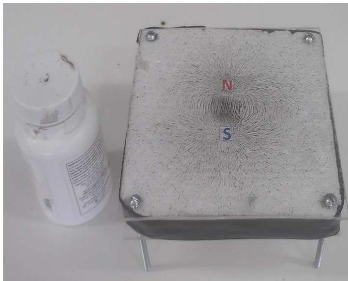
Figura 4 - Experimento para visualização das linhas de fluxo magnético.
