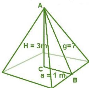
Assim, temos que  $a = L/2 = 1 \text{ m}$ ,  $H = 3 \text{ m}$ , então:  $g^2 = a^2 + H^2 \rightarrow g^2 = 1^2 + 3^2 = 10 \rightarrow g = \sqrt{10} \text{ m} \cong 3,2 \text{ m}$ . Agora, calculando-se a área lateral dos 4 triângulos de base 2 m e  $h = 3,2\text{m}$ , temos:
