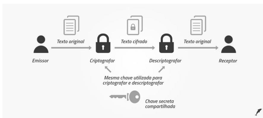
**Figura 1** - Criptografia Simétrica (Fonte: Adaptado E-val. <https://www.evaltec.com.br/criptografia-de-dados-e-gerenciamento-de-chaves/>)
