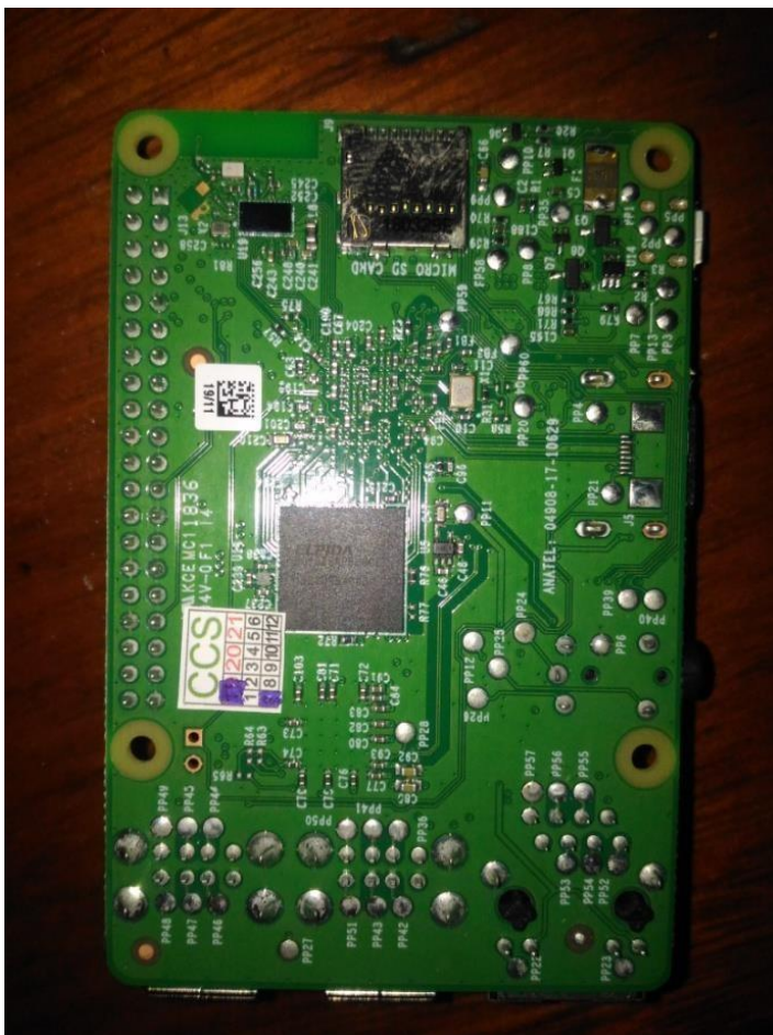
Figura 3 - Parte de trás placa Raspberry-pi
