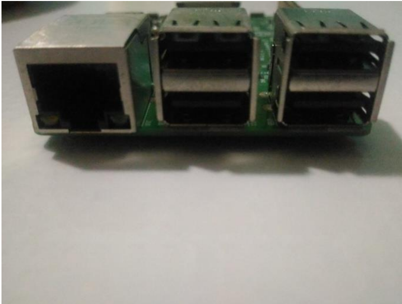
Figura 2 - Entradas USB e Lan da placa Raspberry
