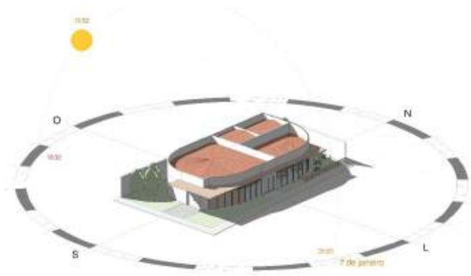
Figura 16 Estudo Solar (Elaborado Pelo autor no revit)
