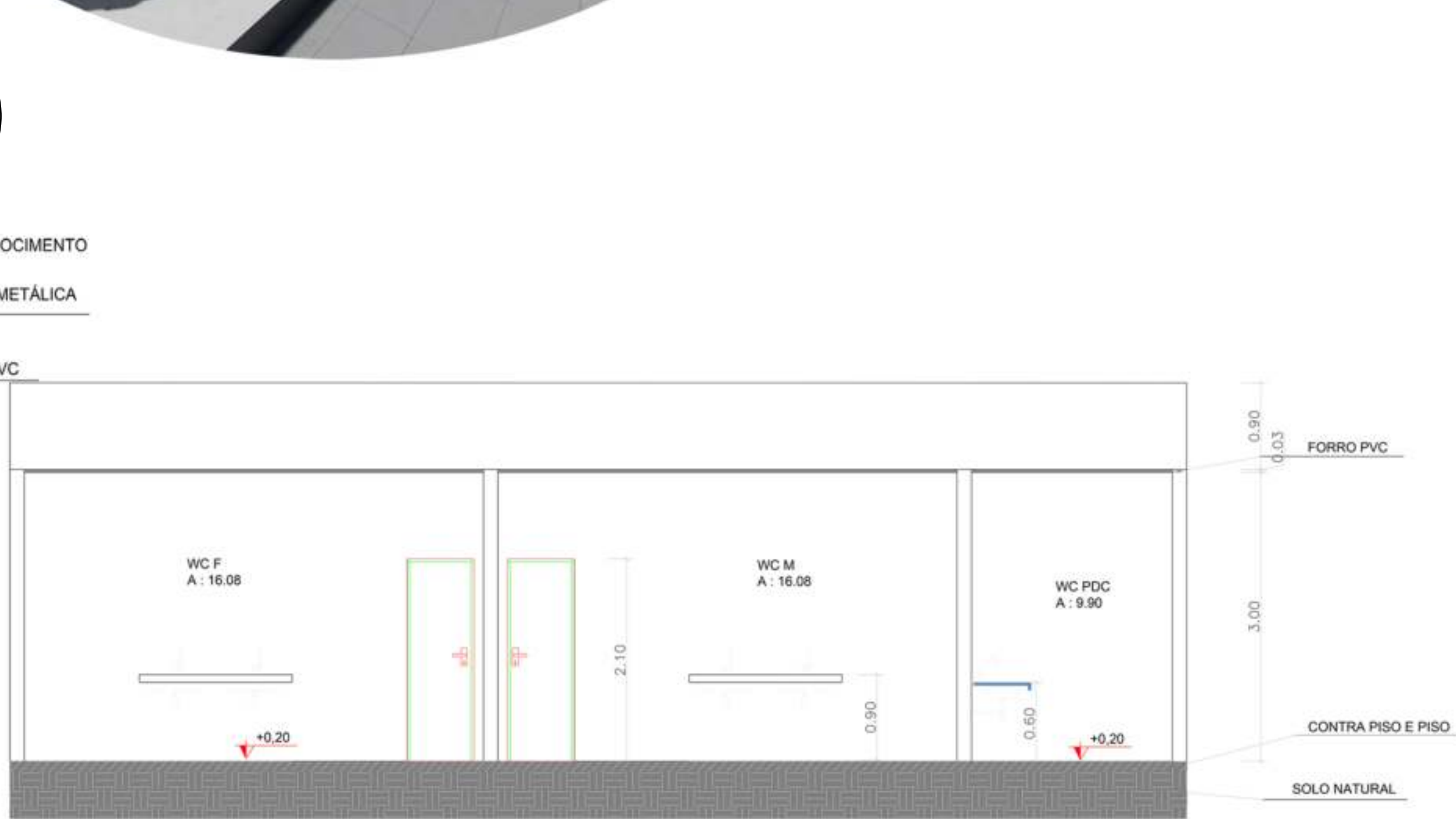
CORTE "A - A" - BANHEIRO ESCALA - 1:20
