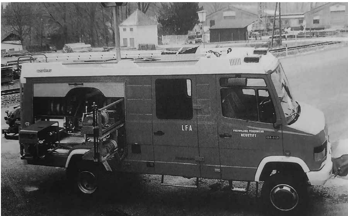
Das neue Löschfahrzeug mit Bergeausrüstung
