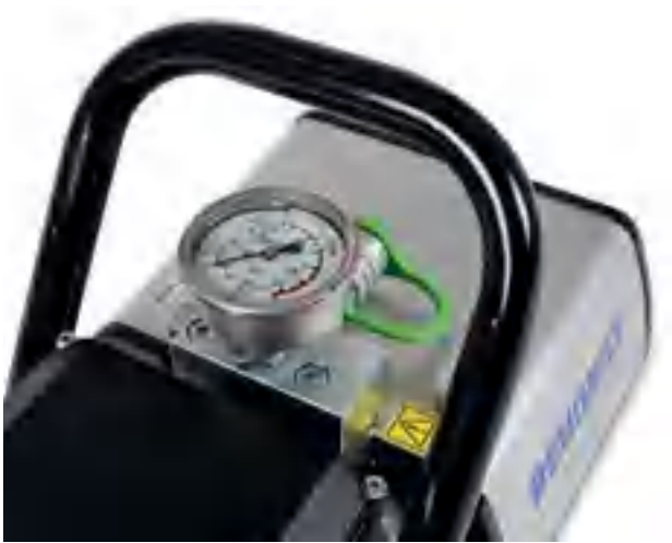
■ Gauge as standard, well protected by the handle ■ Manometer som standard, väl skyddad av handtaget
