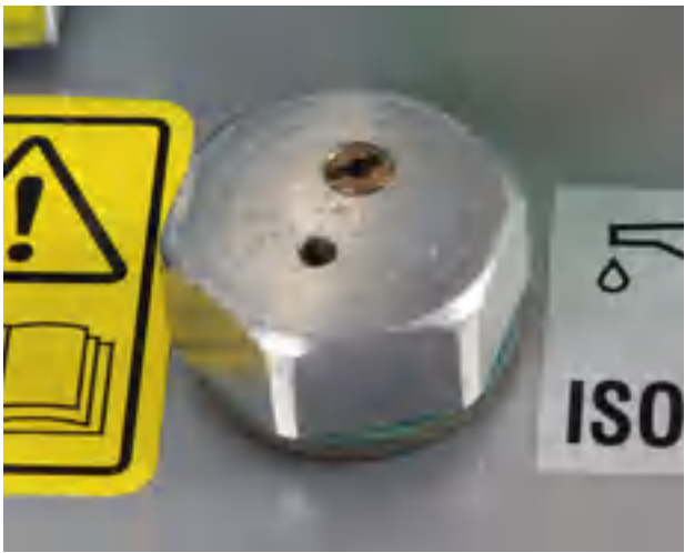
■ Vented non leakage oil refill plug. ■ Ventilerad läckfri oljepåfyllningsplugg
