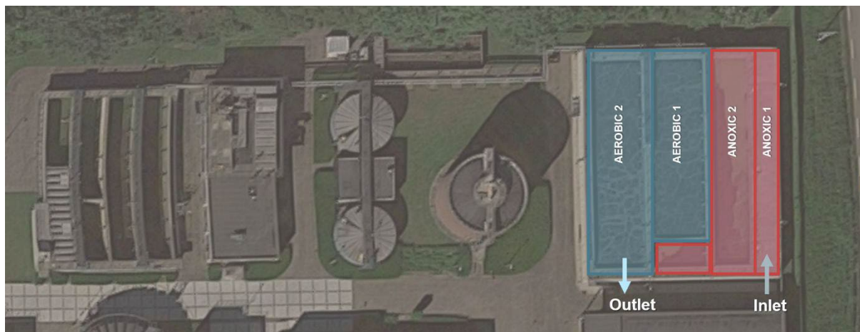
Figuur 1: Indeling en configuratie van de onderzochte industriële afvalwaterzuiveringsinstallatie. Het afvalwater heeft communale kenmerken, maar is sterk dynamisch en kent een vrij hoge ammoniakbelasting.
