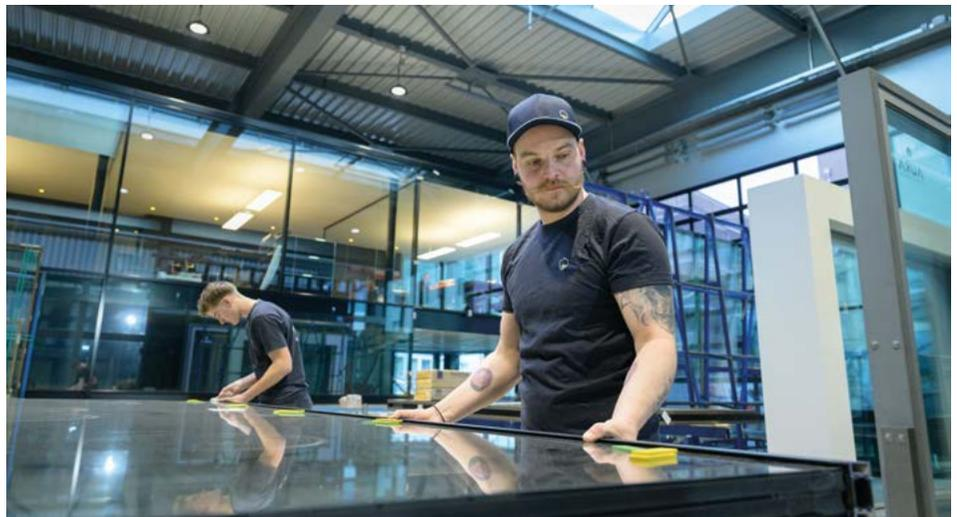
Die Verklebung der bis zu 60 mm dicken Wärmeschutzgläser mit den Flügelprofilen erfolgt unter geschützten Bedingungen im Werk.
