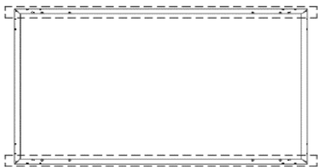
Figure 3 : Installation des modules avec boulons. Rail parallèle au côté long.
