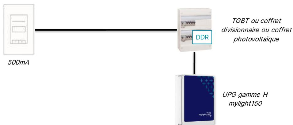
Figure 3. Schéma de raccordement de l'UPG mylight150
