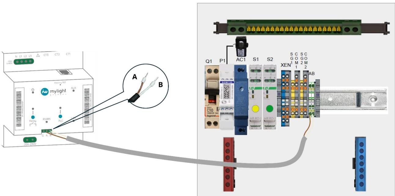
Figure 13. Schéma de raccordement RS485 sur une MG3
