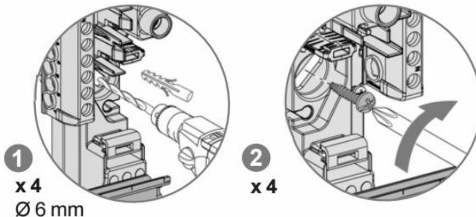
Figure 2. Montage de l'UPG sur un mur
