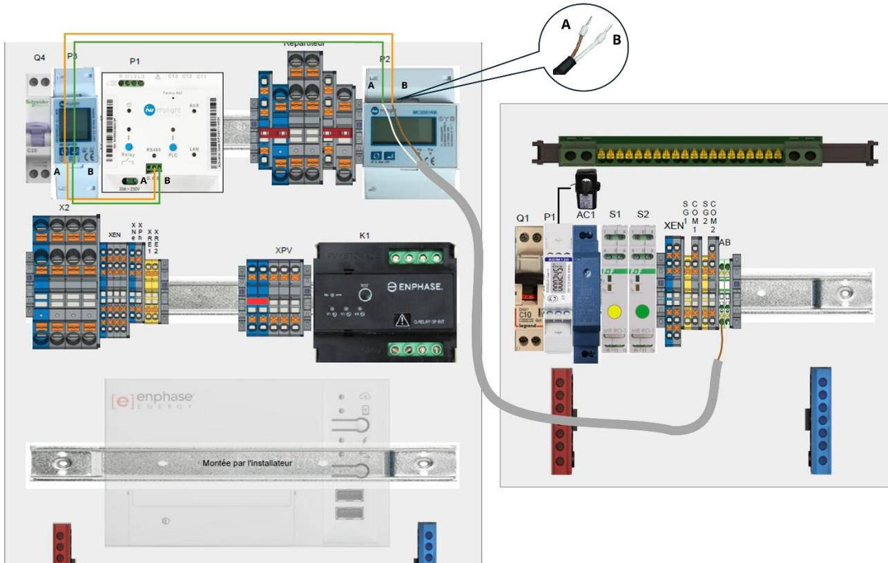
Figure 14. Schéma de raccordement RS485 sur un compteur
