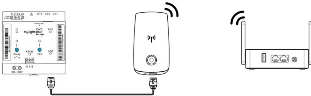
Figure 15 - Schéma de connexion internet via un répéteur Wi-Fi
