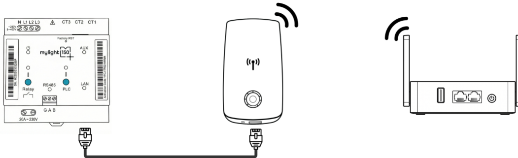
Figure 15 - Schéma de connexion internet via un répéteur Wi-Fi
