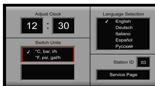
Konfigurationsseite: Einstellung von Uhrzeit, Einheitensystem und Displaysprache, Anzeige der Geräteadresse
