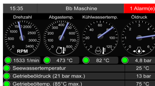
Seite 1: Werte und Statusanzeigen eines Motors
