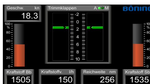
Seite 2: Trimmklappenwinkel, GPS-Geschwindigkeit, Reichweite, Kraftstoffverbrauch, Tankinhalte
