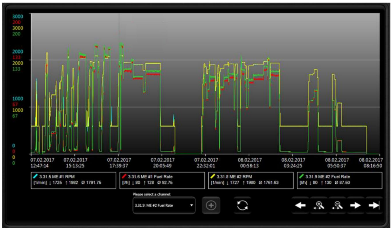
Beispiel 2: Data Logging / Trending-Seite innerhalb der grafischen Systemkonfiguration (Gleichzeitige Darstellung von bis zu 8 Graphen möglich)
