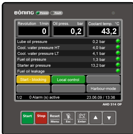
Abbildung 41: Zustand „switch off“
