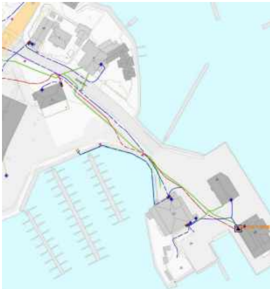
Figur 40: Kartskisse som viser eksisterende høy/lavspennings kabelnett og nettstasjon på holmen fra Agder energi.
